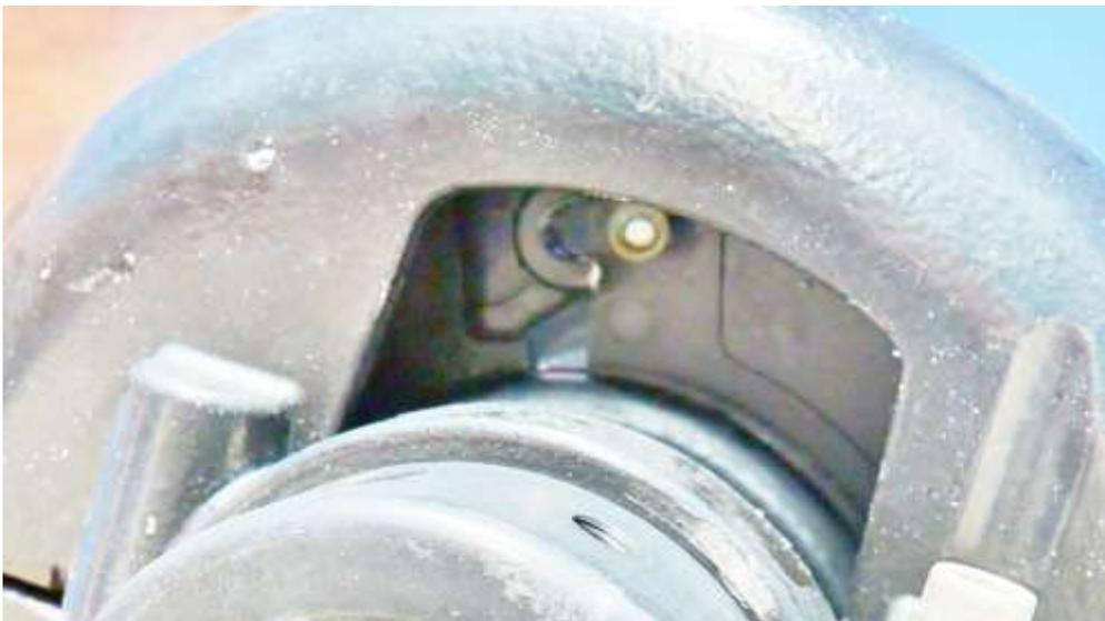
Diese Verschraubung ist ausgebrochen, so etwas dürfte bei einem Qualitätsprodukt nicht vorkommen! Eine potentiell lebensbedrohliche Schwachstelle. Und ohne Verschraubung rutscht die Scheibe, die Reffleine kann die Refftrommel nicht mehr halten, der obige Ablauf muss seinen unaufhaltbaren Weg nehmen.
